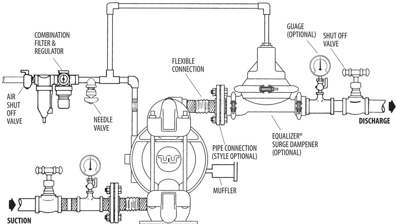
气动泵：如在紧急情况下需要停止正在运行的泵，请直接关闭安装在供气管道中的“切断”阀（用户自行购买）。正常运行的阀门将停止给泵供气，从而使泵停止运转。切断阀必须安装在离泵送设备足够远的位置，以便在紧急情况下可以安全地操作。
