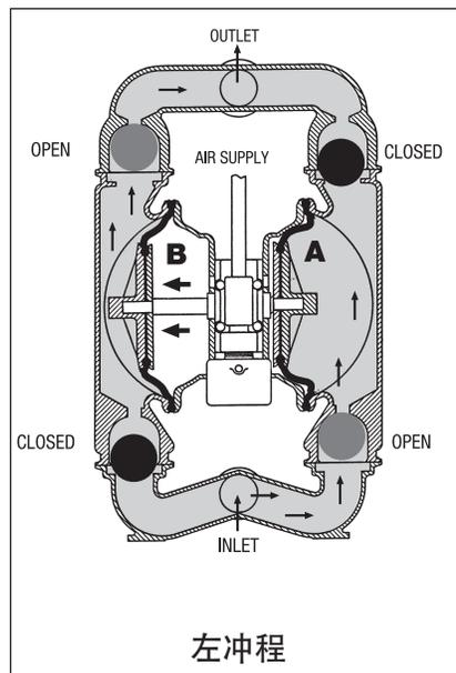
图1 气阀引导压缩空气流至隔膜A的背面。压缩空气直接作用于被弹性体隔膜分开的液体腔。隔膜作为压缩空气和液体之间的隔离膜，平衡负荷并消除隔膜的机械应力。压缩空气将隔膜从泵的中心体位置推开。与隔膜相连的轴将另一侧的隔膜拉入。隔膜B在吸入冲程；隔膜后的空气通过泵的排气口排到泵外。隔膜B向泵的中心体方向移动，从而在腔室B内形成真空。大气压将液体压入进口管，将阀球从阀座上顶起。液体轻松地流经进口阀球，注入液室（见阴影区域）。
