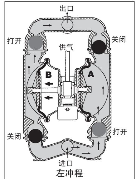
图1 空气阀引导压缩空气流至隔膜A的背面。压缩空气直接作用于被弹性体隔膜分开的液体腔。隔膜作为压缩空气和液体之间的隔离膜，平衡负荷并消除隔膜的机械应力。压缩空气将隔膜从泵的中心体位置推开。与隔膜相连的轴将另一侧的隔膜拉入。隔膜B在吸入冲程；隔膜后的空气通过泵的排气口排到泵外。隔膜B向泵的中心体方向移动，从而在腔室B内形成真空。大气压将液体压入进口管道，将阀球从阀座上顶起。液体轻松地流经进口阀球，注入液体腔室（见阴影区域）。
