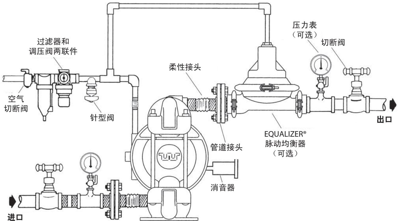
气动泵：如在紧急情况下需要停止正在运行的泵，请直接关闭安装在供气管道中的“切断”阀（用户自行购买）。正常运行的阀门将停止给泵供气，从而使泵停止运转。切断阀必须安装在离泵送设备足够远的位置，以便在紧急情况下可以安全地操作。
