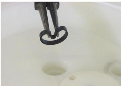
对于新活塞环[22]的组装（仅适用于泵规格E15 - E50），请使用卡簧钳小心地将它们捏成肾形，并将环插入中间泵壳[4]中的槽内（见图15.1）；使用某种圆形工具将环完全且平滑地压入槽。
