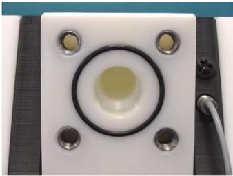
本系列产品提供符合DIN/PN10或ANSI标准的法兰接口。中间泵壳上已预埋用于安装法兰的不锈钢螺纹套（DIN法兰的代码为 F3/F4/F5/F6，ANSI法兰的代码为F3w/F4w/F5w/F6w）。在连接法兰前，应将配带的O形圈放入水管的沟槽内以提高其密封性。法兰O形圈[30]的材质有EPDM（代码F3）、FEP（代码F4）、NBR（代码F5）和FKM（代码F6）
