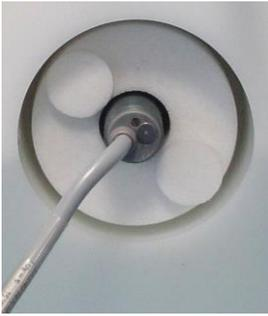
尽管集成金属芯的ALMATEC隔膜能实现其最佳使用寿命，但它仍属于易损件，如有破损，液体将泄漏到中间泵壳，最终从消声器漏出，这种情况通过加装ALMATEC隔膜监测装置可以简单有效地避免。
